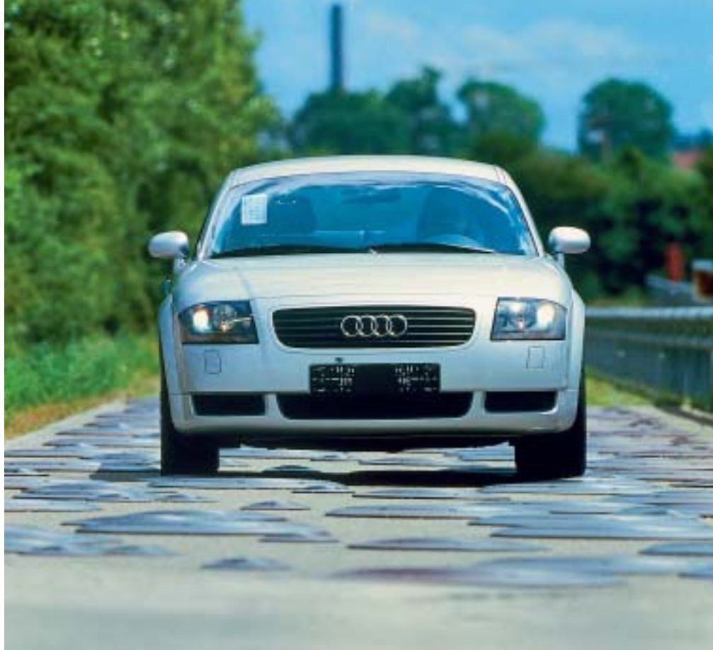
Die Holperstrecke dient der akustischen Prüfung. Jedes leise Klappern wird registriert.
