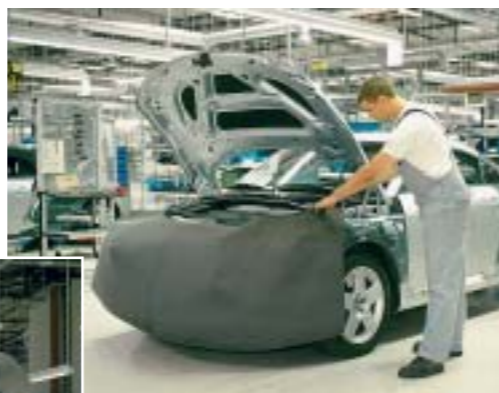
Luft raus: Der einmal geöffnete Bremskreislauf wird hier von Luftbläschen befreit.
